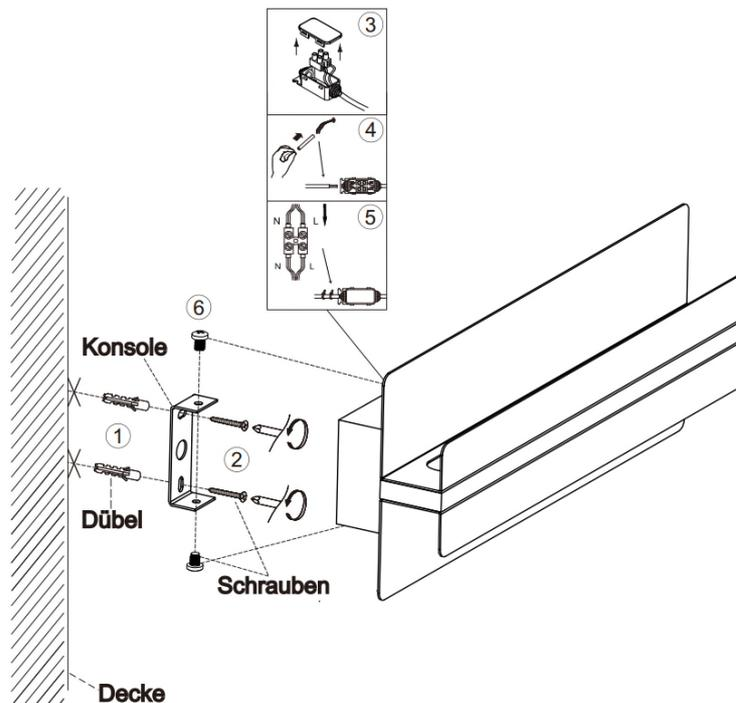
1. Legen Sie an der Wand die Stelle fest, an der die Leuchte später installiert werden soll. Bohren Sie mit einem Bohrer zwei Löcher in die Wand und installieren Sie die Dübel.
