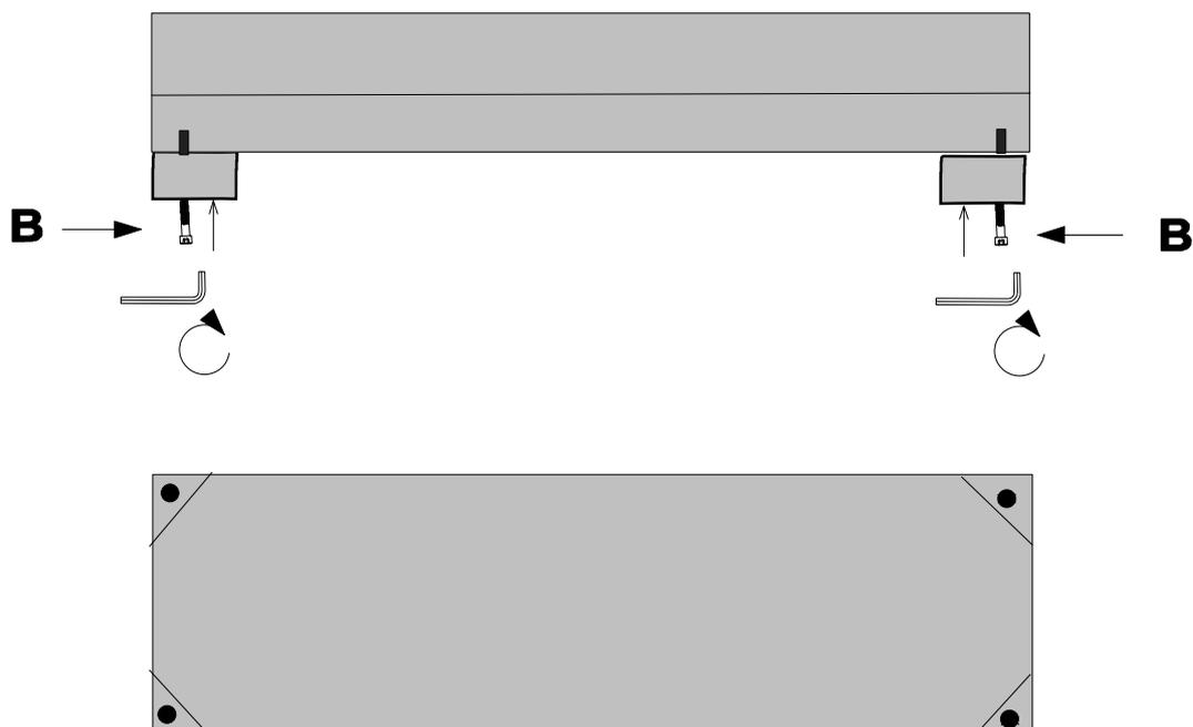
3. Matratzenbügel/-Halter (D) am Fußende mit 2 Schrauben E von unten befestigen. Die Bohrlöcher sind gekennzeichnet.
