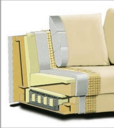
**Die Federkernkombination** ist eine Besonderheit dieses Polsteraufbaus: Stabiles Holzinnengestell, tief liegender Federkern, Kantenstützblock, Sitzkissen aus hochwertigem Polyurethanschaum, schichtweise aufgebaut in verschiedenen Höhen und Härten aufeinander abgestimmt, Rückenauflage aus hochwertigem Polyurethanschaum, Bezug mit Polyestervlies unterstept, loses Rücken- kissen in Daunencharakter, in Kammern gearbeitet und mit Schaumstoffstäbchen und Polyesterfasern gefüllt.
