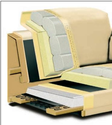
**Der Mehrschichtaufbau** bei boden- freien Konstruktionen: stabiles Holz- innengestell, Stahlwellenunterfe- derung, Sitz- und Rücken- kissen aus hochwertigem Polyurethanschaum, abgedeckt mit einer Matte in Daunen- charakter, die in Kammern gearbeitet und mit Schaumstoffstäbchen und Polyesterfasern gefüllt ist.
