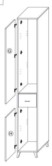
(T11) Bei Türmontage das Scharnier einhängen, bis Anschlag öffnen und anschließend festschrauben.
