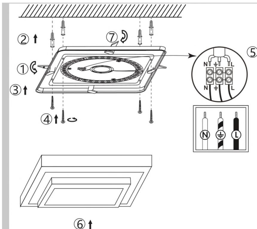
1-2. Entfernen Sie den Lampenschirm, indem Sie ihn mit dem Hebel von der Bodenplatte lösen. Halten Sie die Grundplatte an die Installationsfläche und markieren Sie die Bohrlöcher entsprechend den Befestigungslöchern des Lampensockels. Bohren Sie dann vier (4) Löcher an der markierten Stelle an der Decke. Setzen Sie vier (4) Dübel in die Bohrlöcher ein.
