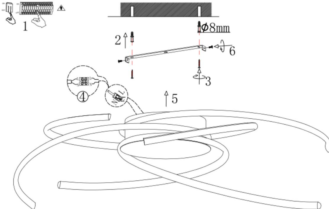
1+3. Legen Sie an der Decke den Platz fest, an dem die Leuchte später installiert werden soll. Bohren Sie mit einem Bohrer – passend zu der Öffnung an der Halterung- 2 Löcher in die Decke, und bringen Sie 2 Deckendübel an. Befestigen Sie die Halterung an der Decke, indem Sie die Schraube anziehen.
