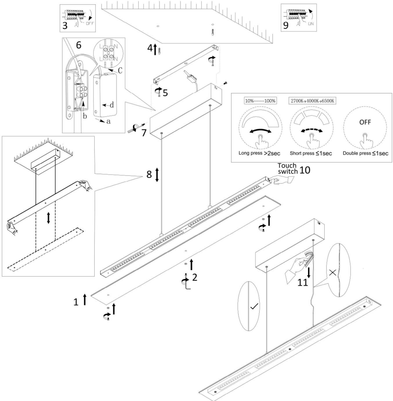
Einstellung der Seilrolle: Diese Arbeiten dürfen nur von einem Fachmann durchgeführt werden
