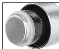
Inserire la guarnizione ad anello in modo che il lato aperto sia rivolto verso l'inserto in plastica della chiusura e che il bordo interno scorra nell'incavo.
