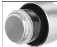
Setzen Sie den Dichtungsring so ein, dass die offene Seite in Richtung Kunststoff-Einsatz des Verschlusses zeigt und der innere Rand in die Ausparung rutscht.
